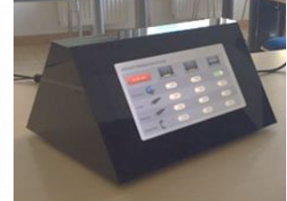
Touch-Panel zur Mediensteuerung
